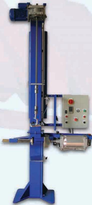
L'apparecchiatura consente di svitare o serrare valvole su bombole di CO<sub>2</sub> di qualsiasi capacità. È provvista di una morsa pneumatica che consente di bloccare serbatoi da 2 a 50 kg. di capacità. Il serraggio ha la coppia impostabile da tastiera con bloccaggio automatico. È provvista di comando bimanuale nel rispetto delle norme antinfortunistiche.
