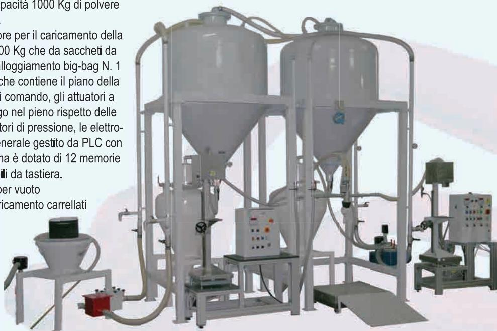
L'apparecchiatura 1753 ha integrato il controllo della carica in automatico ce permette di riempire serbatoi per estintori a polvere da 1 a 100 Kg di capacità approvvigionandosi direttamente da big-bag da 1000 Kg.
