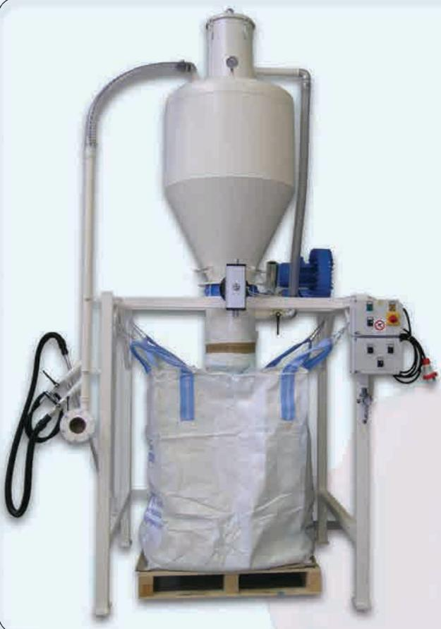
L'apparecchiatura consente di recuperare in sacconi da 1.000 kg. la polvere da smaltire, direttamente da estintori portatili o carrellati sia pressurizzati che non pressurizzati senza nessun tipo di inquinamento ambientale. I comandi sia elettrici che pneumatici sono posizionati in due centraline in posizione facilmente raggiungibile dall'operatore. La velocità di recupero è di circa 3.000 kg. di polvere al giorno.
