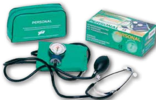
Scala 0-300 mmhg. Bracciale in nylon con chiusura a velcro. Fonendoscopio a testa piatta fissato sul bracciale, custodia in similpelle con cerniera.
