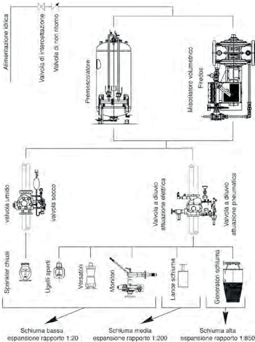
Gli impianti a schiuma possono essere a bassa, media, od alta espansione, per applicazione localizzata o a saturazione d'ambiente, e sono tra gli impianti più diffusi nell'ambito industriale per il basso costo, l'elevata capacità estinguente e la facilità di utilizzo.
