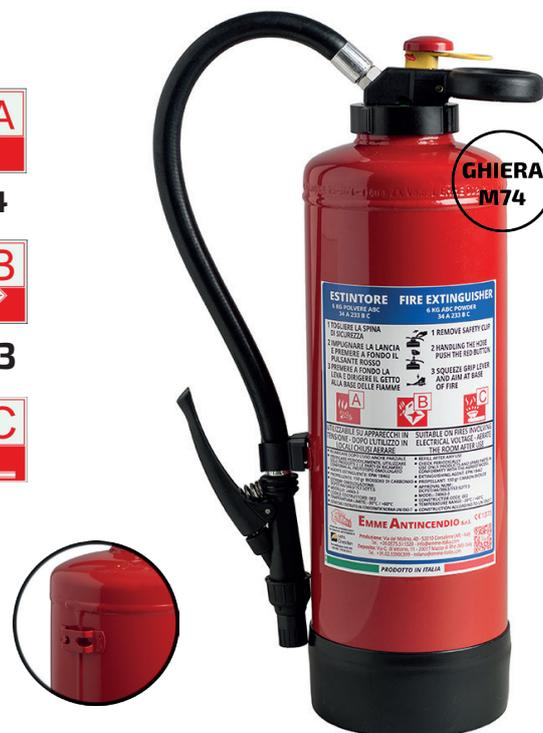
Estintore a polvere polivalente ABC dotato di bombolina interna di pressurizzazione. La pressurizzazione al momento dell'uso garantisce una costanza nell'erogazione controllando il getto con la pistola posizionata all'estremità della manichetta. Realizzato in acciaio al carbonio a tre saldature e clip posteriore.
