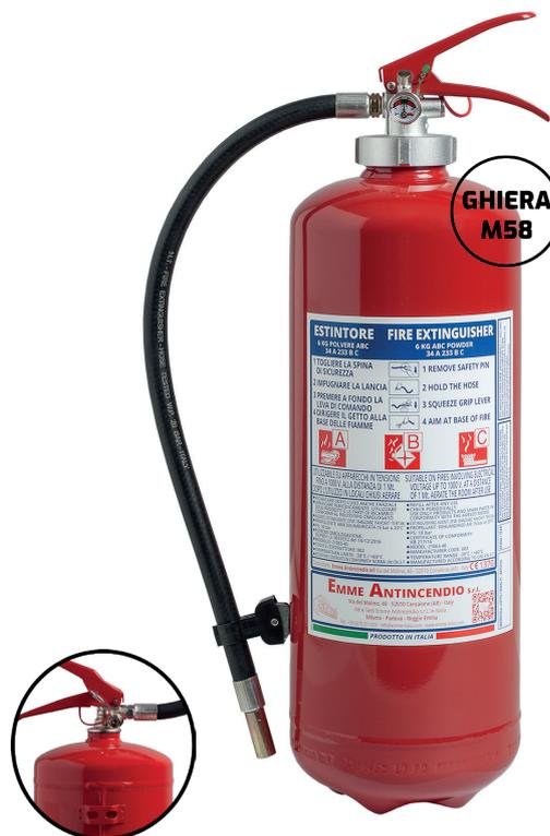
Estintore a polvere polivalente ABC dotato di manichetta di erogazione in gomma con ugello in ottone. Realizzato in acciaio al carbonio a profondo stampaggio con valvola in alluminio.
