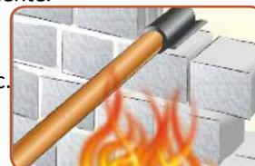
**EI 120 - EN 1366-3 Bandes termoependenti pour tuyau combustibles. (PVC, PE, PEHD ecc.) Appliquer à l'interne de la maçonnerie**
