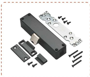
Troisième point de clôture, ambidextre, support en aluminium verni noir, serrure en zamak nickelées et pièce en matériel plastic auto lubrifiantes pré-assemble
