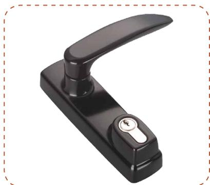
Commande externe, poignée zamak peint au point mort et acier galvanisé, poignée en alu moulé sous pression peint, cylindre européen avec différentes combinaisons, 3 chiavi nichelate, 3 clés nickelé, mât carré en acier galvanisé blanc 1 vis TCEI M5x30 et 2 vis TS M5x80 en acier galvanisé. Il est doté de dispositif en copropriété.
