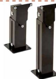
Colonne extensible à section carrée mm. 40 x 40 pour le fixation horizontal mural ou vertical au sol des électro-aimants pour portes coupe-feu - Corps en acier peint en noir. Plaque pour le fixation de l'électro-aimant orientable de 180°
