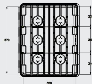
1 Caisse et couvercle avec une structure renforcée
