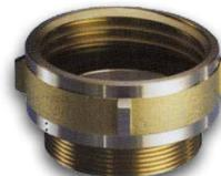
En latón EN 1982, ataque hembra roscado UNI 811, ataque macho roscado GAS ISO 228
