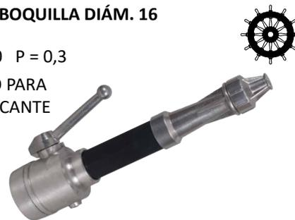
Lanza contra incendios a chorro multiplo. Totalmente construida en aleacion de aluminio ligera con juntas en goma. Funciona a traves de una valvula a esfera a traves de un dispositivo produce un amplio chorro de agua fraccionada.
