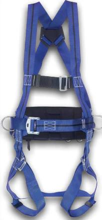
Arnés a 1 punto de ataque dorsal en cinta tejible de poliamida azul con línea negra con contraste de 45 mm. con cinturón de posicionamiento dotada de hebilla en acero galvanizado. Anillos dorsales y laterales en acero inoxidable, hebillas a apertura rápida y quijotes regulables. Peso 1 kg Categoría DPI: 3 Quality Assurance: ISO 9001 / 2000
