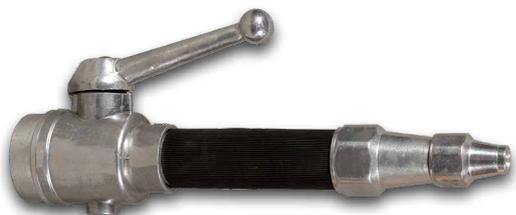
Lanza contra incendios a chorro conforme a la norma UNI EN 671-2. Totalmente construida en aleación de aluminio ligera con juntas en goma. Funciona a través de una válvula a esfera y a través de un dispositivo que produce un mplio chorro de agua fraccionada.
