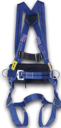
Arnés TITAN a 2 puntos de ataque, dorsal y eternal. Cinta tejible de poliamida 45 mm azul con línea negra con contraste en la parte exterior. Cinturón de posicionamiento, anillos laterales, hebillas a apertura rápida en acero inoxidable y quijotes regulables. Peso: 1 kg. Categoría DPI: 3 Quality Assurance: ISO 9001 / 2000
