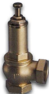
En latón, ataque roscado hembra GAS ISO 228, salida roscada hembra GAS ISO 228, calibrada 12 Bar
