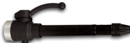
Lanza contra incendios a chorro conforme a la norma UNI EN 671-2. Compuesta de cuerpo en aluminio recubierto, juntas en goma, caña en resina ABS antiurto con ranuras de toma antideslizante y boquilla en polimero reforzado. Funciona a través de una válvula a esfera y a través de un dispositivo y produce un amplio chorro de agua fraccionada. La palanca de comando permite el pasaje de cerrado a chorro leno o fraccionado. En posición de chorro lleno se garantiza un pasaje de agua omogeneo.
