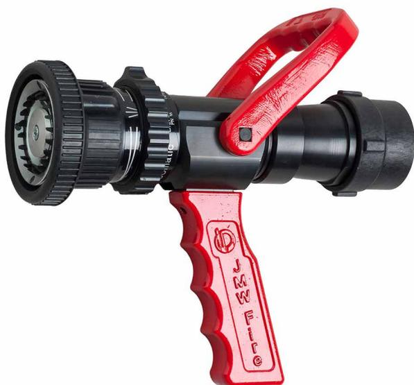
Lanza Spray Jet 2" Uso profesional-chorro lleno-spray-velo de proteccion Angulo de suministro del chorro (30° -120° ) para la optimizzacion del efecto de apagado. Capacidad 100/300 L/min
