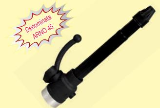
Lancia antincendio a getto conforme alla norma UNI EN 671-2. Composta da corpo in alluminio rivestito, guarnizioni in gomma, canna in resina ABS antiurto con scanalature di presa antiscivolo ed ugello in polimero rinforzato. Funziona mediante valvola a sfera e tramite un dispositivo produce un largo getto di acqua frazionata. La leva di comando permette il passaggio da chiuso a getto pieno o frazionato. In posizione di getto pieno è garantito un passaggio d'acqua omogeneo..
