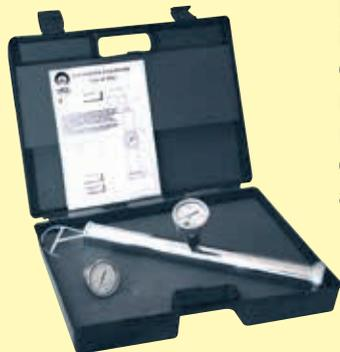
Il tubo di Pitot permette di misurare la pressione dinamica e la velocità di un fluido in movimento oltre a ricavare la portata di una bocca di erogazione, di diametro noto, di un qualsiasi sistema idraulico e in modo specifico di una lancia di erogazione d'acqua collegata ad un impianto idraulico antincendio.
