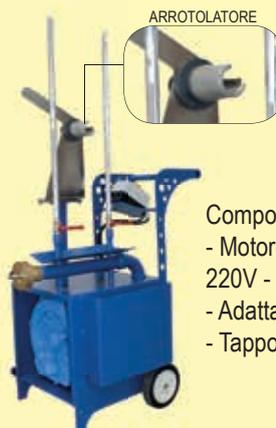
Apparecchiatura per l'asciugatura di serbatoi per estintori portatili e manichette antincendio, provvista di arrotolatore.
