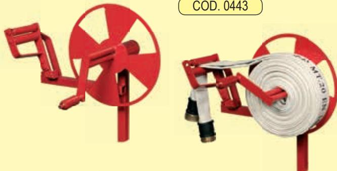
Avvolgimanichetta fissata alla morsa o nell'alloggiamento apposto nel macchinario Family05. Permette la facile, rapida e corretta riavvolgitura dei tubi, con un'adeguata eliminazione dell'acqua all'interno della manichetta. Utilissimo per prove pratiche antincendio e per il riavvolgimento dopo il collaudo idraulico previsto dalla norma UNI EN 671-3.
