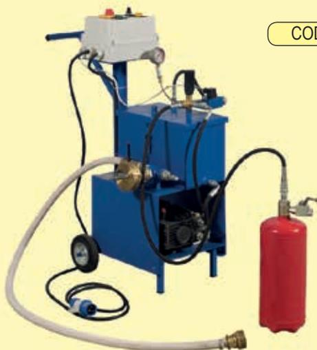
Apparecchiatura per il collaudo idrico fino a 35 atm di serbatoi per estintori portatili ed a 12/15 atm per manichette UNI 70 ed UNI 45 provvista di serbatoio di riserva d'acqua da 10 Lt. e raccordo 30x1,5
