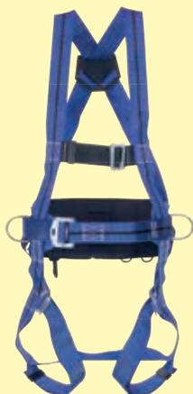
Imbracatura ad 1 punto di attacco dorsale in nastro tessile di poliammide blu con riga nera a contrasto da 45 mm. con cintura di posizionamento dotata di fibbia in acciaio galvanizzato. Anelli dorsale e laterali in acciaio inossidabile, fibbie ad apertura rapida e cosciali regolabili. Peso 1 kg
