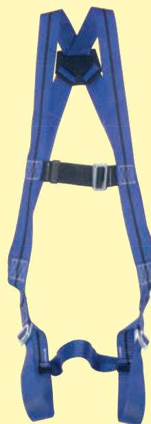
Imbracatura ad 1 punto di attacco dorsale con anello a D in acciaio galvanizzato. Nastro tessile blu con linea nera in poliammide 45 mm. Fibbia in acciaio galvanizzato ad apertura rapida. Peso 500 gr
