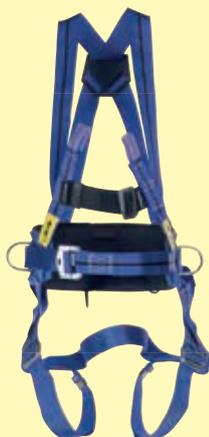
Imbracatura TITAN a 2 punti di attacco, dorsale e sternale. Nastro tessile in poliammide 45mm blu con riga a contrasto nera sulla parte esterna. Cintura di posizionamento, anelli laterali e fibbie ad apertura rapida in acciaio inossidabile; cosciali regolabili. Peso: 1 kg.
