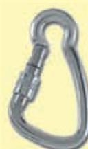
Moschettone a ghiera in alluminio con apertura 21 mm. Peso 0,082 Kg Resistenza alla rottura > 22kN. I connettori di ancoraggio sono utilizzati per fissare un attacco intermedio a un punto di ancoraggio
